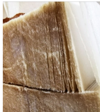
Schimmelpilze auf dem Filtermaterial
