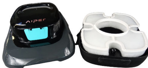
Abb. 1 Roboter geöffnet mit Filtergitter
