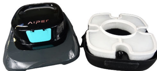
Fig. 1 Robot ouvert avec grille
