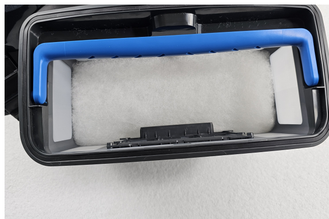
Abb. 2 Großer Feinstfilter oben – fertig
